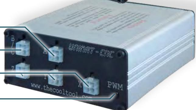
Die **CoolCNC®** Steuerbox gibt es in einer 3- [Lin-Contr3] oder einer 5-Achsen [Lin-Contr5] Variante. Es können Schrittmotoren mit bis zu 2 A pro Phase angesteuert werden. Sondervarianten bis zu 5 A pro Phase auf Anfrage.
